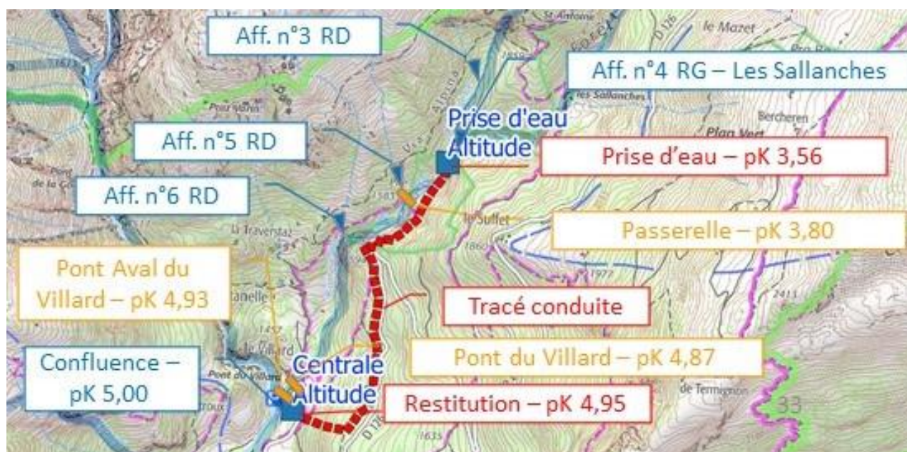
Figure 13 – Carte Igm 1/25000 ème synthétisant la localisation des ouvrages situés entre la prise d'eau et la centrale, au sein du tronçon court-circuité
